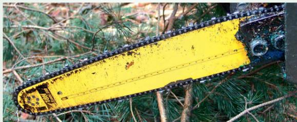
Abb. 12: Stubbenbehandlung per Harvester mit speziellem Schnittsystem (Lochschwert)
